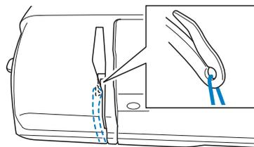
**11** Faites glisser le fil derrière le guide-fil de la barre de l'aiguille.
