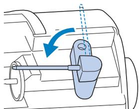
**6** Placez la bobine de fil supérieur pour l'aiguille droite sur le porte-bobine horizontal, puis fixez-la avec le couvercle de bobine.
