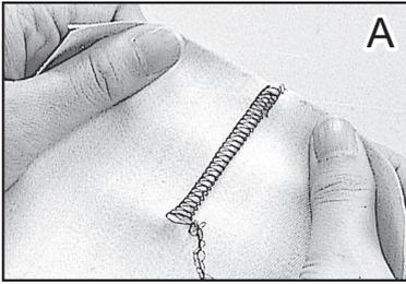
Utilisez le flatlock à 2 fils comme le précédent à 3 fils, puis tirez les deux épaisseurs de tissu jusqu'à ce que le point soit ouvert à plat (fig. A). Les points étant visibles à l'endroit comme à l'envers, le flatlock est considéré comme une application décorative (fig. B). Faites un essai afin de vous assurer que le tissu correspond à l'emploi que vous voulez en faire, notamment lors de son extension à l'ouverture.
