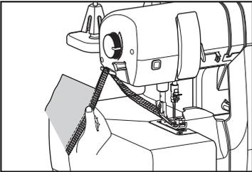
Il y a un coupe-fil intégré à gauche de la machine. A la fin de la couture, sortez la chaînette du tissu en continuant d'actionner la machine sur 15 cm environ.
