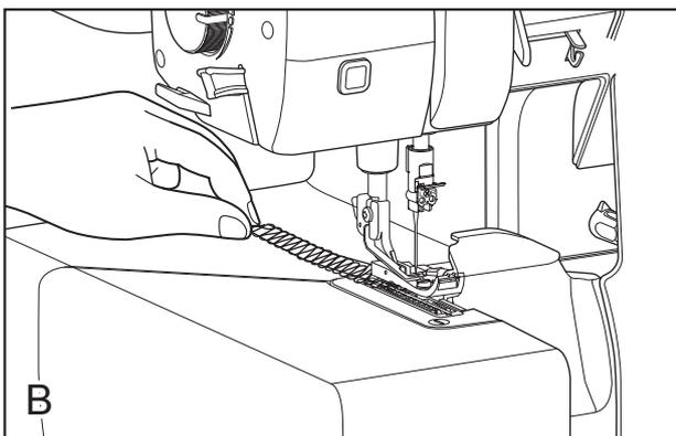
Pour nettoyer les languettes de la plaque aiguille, simplement soulevez le pied presseur, ce qui enlève toutes les tensions, levez l'aiguille ou les aiguilles (fig. B). À ce moment, tirez les fils doucement derrière le pied. Les points sont maintenant relâchés des languettes (fig. C).
