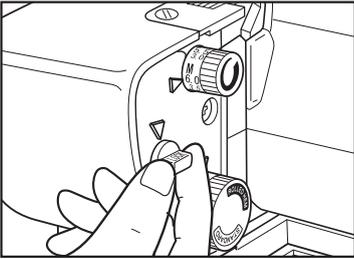
Quand il n'y a pas de coupe requise comme lorsque vous cousez sur un pli, tournez le bouton de blocage du couteau dans le sens inverse des aiguilles d'une montre à la position «LOCK». Le couteau ne bouge plus de haut en bas, mais reste dans la position basse. Pour réengager le couteau, tournez le bouton de blocage d'un demi tour dans le sens des aiguilles d'une montre. Le couteau se remettra en marche automatiquement au commencement de la couture.
