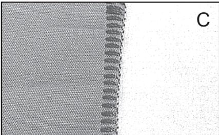
Paramétrez la machine pour une largeur flatlock à 2 fils mais le trajet d'enfilage d'aiguille est différent pour cette technique.
