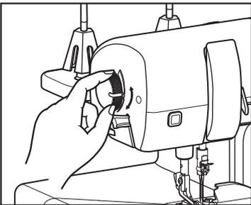
La pression du pied-de-biche a été préréglée à l'usine et a rarement besoin d'ajustement.
