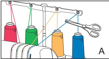
1. Coupez le fil existant du cône et retirez le cône de l'axe (fig. A).
